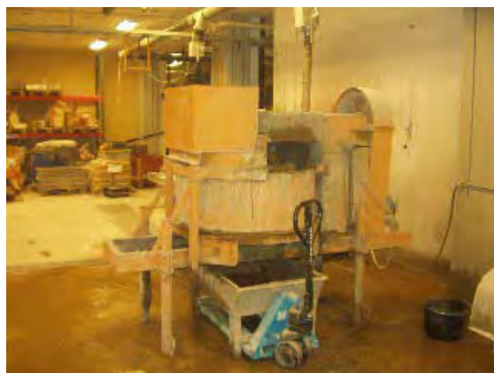
Fig. 6.3: Betongblandaren, av typen tvångsblandare, som användes vid tillverkningen av betongen.
