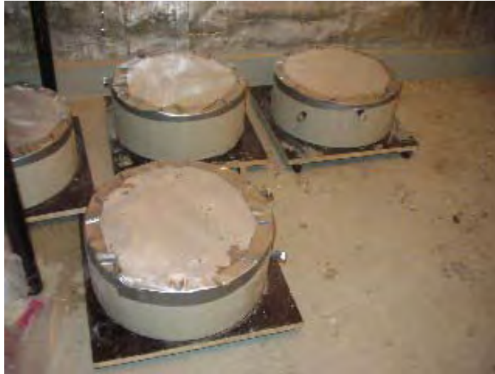
Fig. 6.6: Provkroppar under membranhärdning
