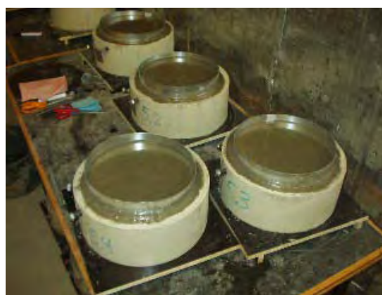
Fig. 6.4: Provkoppar för regnsimulering, direkt efter gjutning.
